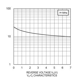
CAPACITANCE BETWEEN TERMINALS:C<sub>t</sub>(pF)
