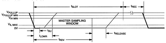
$\mu$ s  $\leq$  t<sub>SLOT</sub> < 120  $\mu$ s  $\mu$ s  $\leq$  t<sub>LOWR</sub> < 15  $\mu$ s  $\leq$  t<sub>RELEASE</sub> < 45  $\mu$ s  $\mu$ s  $\leq$  t<sub>REC</sub> <  $\infty$ t<sub>RDV</sub> = 15  $\mu$ s t<sub>SU</sub> < 1  $\mu$ s
