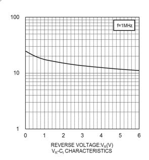
CAPACITANCE BETWEEN TERMINALS:C<sub>t</sub>(pF)
