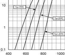
$\begin{array}{l} \mathsf{FORWARD} \, \mathsf{VOLTAGE:} V_{\mathsf{F}}(\mathsf{mV}) \\ V_{\mathsf{F}}\text{-} I_{\mathsf{F}} \, \mathsf{CHARACTERISTICS} \end{array}$
