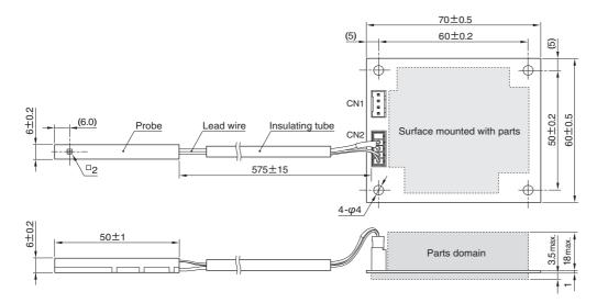
CN1 DF1BZ-4P-2.5DSA HRS Connector (I/O pins)
