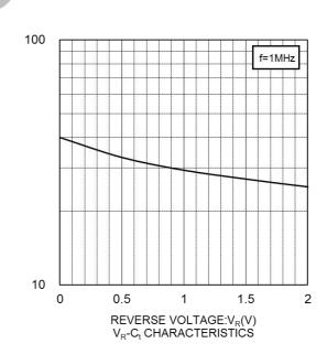
CAPACITANCE BETWEEN TERMINALS:C<sub>f</sub>(pF)
