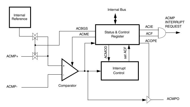
Figure 8-2. Analog Comparator 5V (ACMP5) Block Diagram
