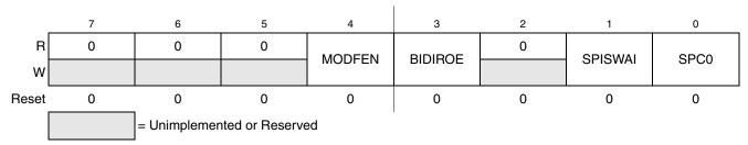
Figure 15-6. SPI Control Register 2 (SPIC2)
