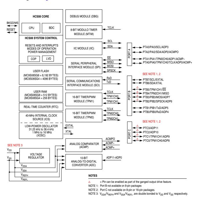
Figure 1-1. MC9S08SG8 Block Diagram
