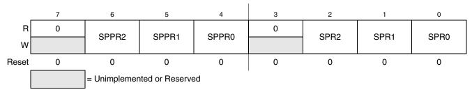
Figure 15-7. SPI Baud Rate Register (SPIBR)
