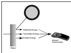
Infrarot-Thermometer messen die Oberflächen-temperatur eines Objekts (target). Die Optik des Gerätes erfasst die emittierte (E), reflektierte (R) und durchgelassene (T) Wärmestrahlung, die gebündelt und auf einen Detektor fokussiert wird. Die Geräteelektronik wandelt diese Information in einen Temperaturwert um, der auf dem Display angezeigt wird. Der Laser wird lediglich zum Zielen verwendet.
