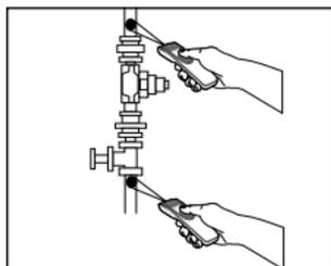
Zur Temperaturbestimmung wird das Gerät auf ein Objekt gerichtet und die Meßtaste gedrückt. Denken Sie daran, das Verhältnis von Entfernung zu Punktgröße sowie das Sichtfeld zu berücksichtigen. Falls das Gerät mit einem Laser ausgerüstet ist, benutzen Sie den Laser bitte nur zum Zielen. Siehe Abschnitt „Korrekte Temperaturbestimmung“.
