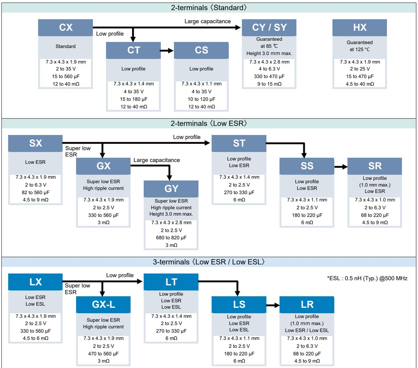
Voltage - Capacitance table (Vol. : 2.0 to 6.3 V / Cap. : 10 to 120  $\mu$ F)
