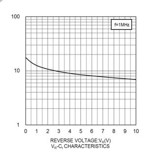
CAPACITANCE BETWEEN TERMINALS:C<sub>t</sub>(pF)
