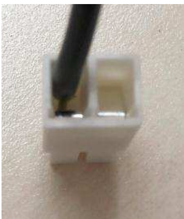
插线之后检查线材有没有插到位
