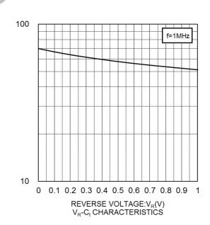
CAPACITANCE BETWEEN TERMINALS:C<sub>(</sub>(pF)
