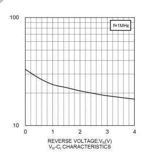
CAPACITANCE BETWEEN TERMINALS:C<sub>f</sub>(pF)
