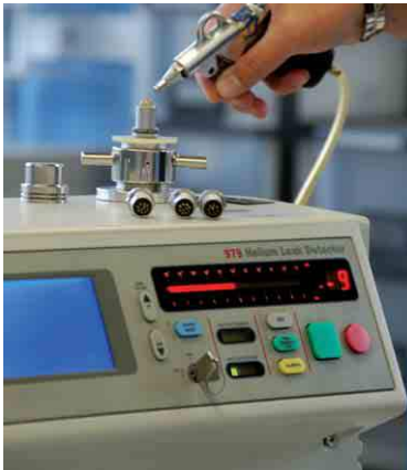
Vacuumtest with leakdetector Vakuumtest mit Leakdetektor
