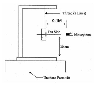
0.1 METER FROM MICROPHONE TO FAN INTAKE
