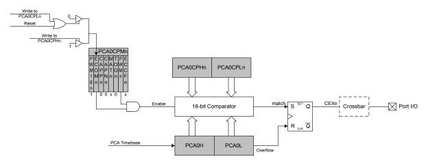
Figure 19.9. PCA 16-Bit PWM Mode
