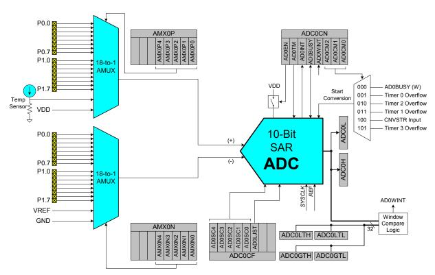
Figure 1.10. 10-Bit ADC Block Diagram
