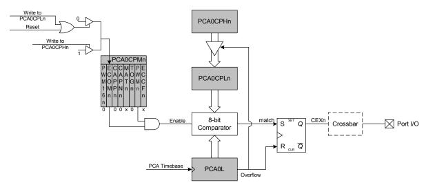
Figure 19.8. PCA 8-Bit PWM Mode Diagram
