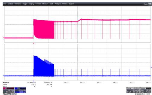
Figure 45 – 300 VAC 50 Hz. CH2: V_{DS} , 100 V / div., 5 ms / div. CH3: I_{DS} , 100 mA / div., 5 ms / div. V_{DS(MAX)} = 427 V. I_{DS(MAX)} = 462 mA.
