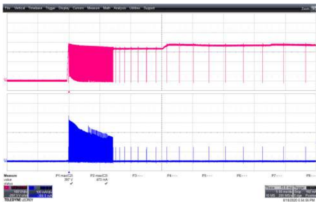
Figure 44 – 277 VAC 50 Hz. CH2: V_{DS} , 100 V / div., 5 ms / div. CH3: I_{DS} , 100 mA / div., 5 ms / div. V_{DS(MAX)} = 397 V. I_{DS(MAX)} = 473 mA.
