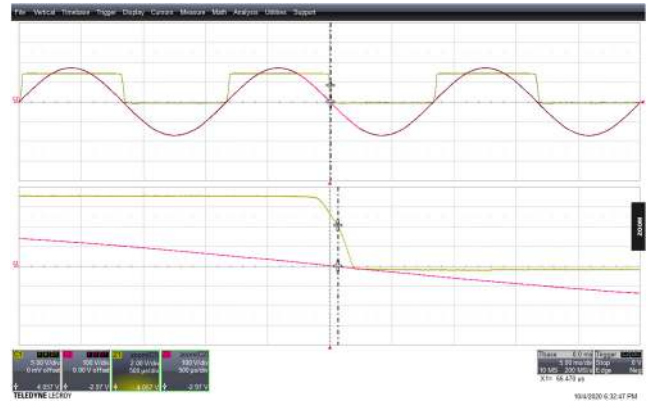
Figure 23 – 115 VAC 60 Hz. CH1: ZCD, 5 V / div., 5 ms / div. CH2: V_{IN} , 100 V / div., 5 ms / div. Rising Edge Delay = 66 \mu s.
