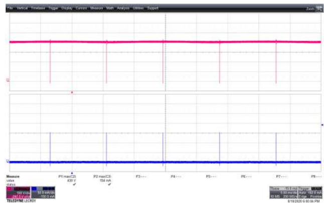
Figure 37 – 300 VAC 60 Hz. CH2: V_{DS} , 100 V / div., 10 \mu s / div. CH3: I_{DS} , 50 mA / div., 10 \mu s / div. V_{DS(MAX)} = 430 V. I_{DS(MAX)} = 154 mA.
