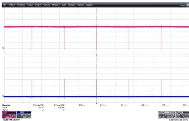
Figure 36 – 277 VAC 60 Hz. CH2: V_{DS} , 100 V / div., 10 \mu s / div. CH3: I_{DS} , 50 mA / div., 10 \mu s / div. V_{DS(MAX)} = 397 V. I_{DS(MAX)} = 153 mA.
