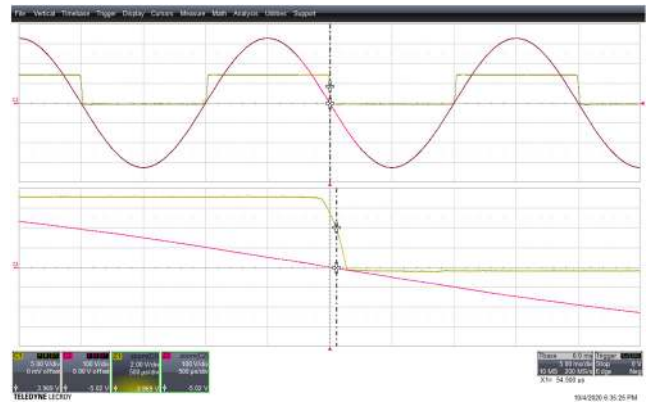
Figure 25 – 230 VAC 50 Hz. CH1: ZCD, 5 V / div., 5 ms / div. CH2: V_{IN} , 100 V / div., 5 ms / div. Rising Edge Delay = 55 \mu s.
