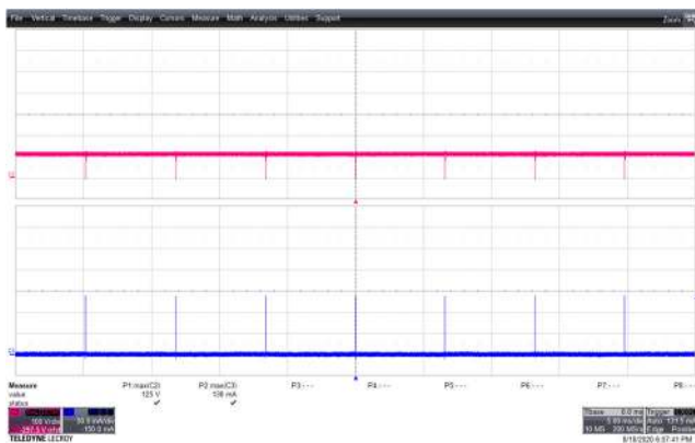
Figure 34 – 90 VAC 60 Hz. CH2: V_{DS} , 100 V / div., 10 \mu s / div. CH3: I_{DS} , 50 mA / div., 10 \mu s / div. V_{DS(MAX)} = 125 V. I_{DS(MAX)} = 138 mA.
