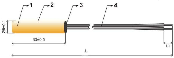
$L = 870 \pm 10 \text{ mm}$  $L1 = 4 \pm 1 \text{ mm}$
