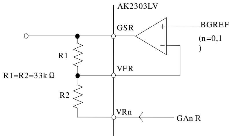
◎基準電圧安定回路
