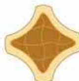
Sezione del conduttore crimpato ottenuta con attrezzo Molex a crimpare con 4+4 tacche Codice 8500.7930.0
