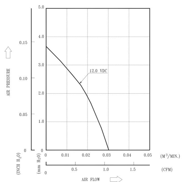
\*TEST CONDITION: INPUT VOLTAGE-----OPÉRATION VOLTAGE TEMPERATURE-----ROOM TEMPERATURE HUMIDITY-----65%RH
