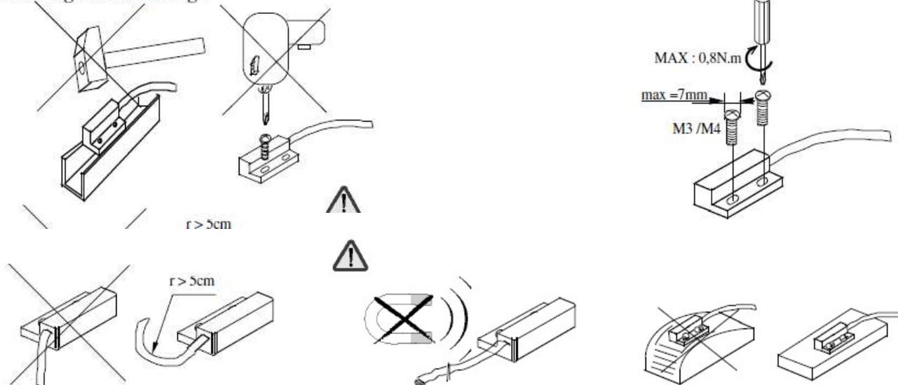
Utiliser des vis M3 et des rondelles Ø 3. Couple de serrage 0,5 Nm /
