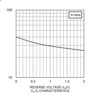
CAPACITANCE BETWEEN TERMINALS:C<sub>f</sub>(pF)
