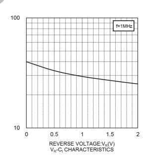
CAPACITANCE BETWEEN TERMINALS:C<sub>f</sub>(pF)
