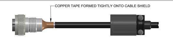
**STEP 6:** SLIDE INSULATOR WITH THE COPPER TAPE INTO THE BACK OF THE PLUG HOUSING. FORM FREE END OF COPPER TAPE TIGHTLY ONTO THE SHIELD OF THE CABLE. MAKE CERTAIN NEITHER THE COPPER TAPE NOR THE CABLE SHIELDING TOUCH ANY OF THE TERMINALS.
