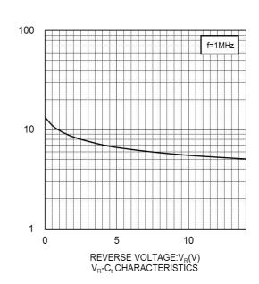
CAPACITANCE BETWEEN TERMINALS:C<sub>t</sub>(pF)
