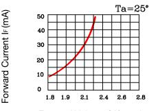
Forward Voltage (VF) - volts
