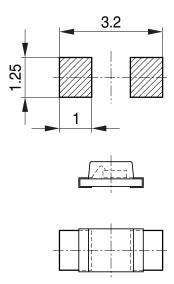
Bauteil positioniert Component location on pad OHFP2578
