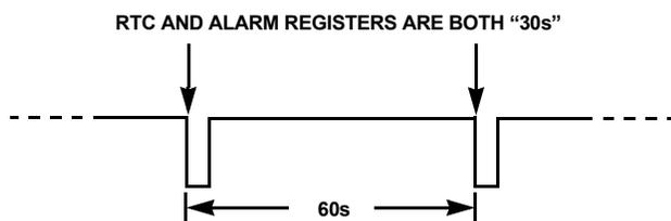
FIGURE 15.  $\overline{\text{IRQ}}/\text{F}_{\text{OUT}}$  WAVEFORM
