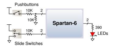
PushbuttonsSlide SwitchesLEDsBTNU: E4SW0: U7LD0: V15BTND: F5SW1: V7LD1: N12
