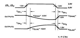
\*VOLAC AND VOHAC ARE THE MEASURED OUTPUT VOLTAGE LEVELS WHILE ENABLED.
