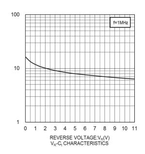
CAPACITANCE BETWEEN TERMINALS:C<sub>t</sub>(pF)
