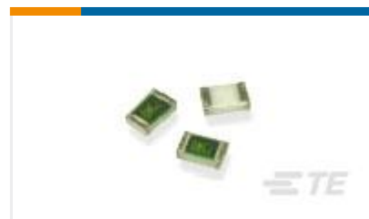
TE Part #1676231-2 RN 0805 1K3 0.1% 10PPM 1KRL
