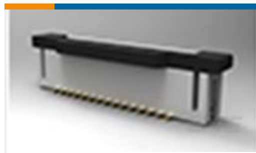
TE Part #2-1734248-4 1.0 FPC, ZIF V/T, SMT, 24P
