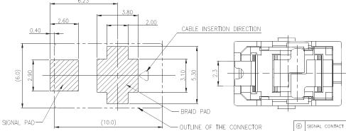
RECOMMENDED PCB LAYOUT NOTE: TOLERANCE FOR PCB LAYOUT IS ±0.05mm
