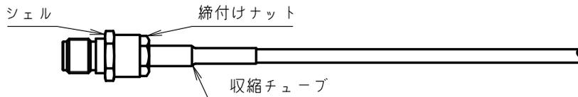
⑤ シェルを装着し、締付ナットをスライドさせ、スパナ等で締め付ける。収縮チューブを締付ナットの根元までスライドさせて、ドライヤー等で加熱し密着させて作業を終了する。
