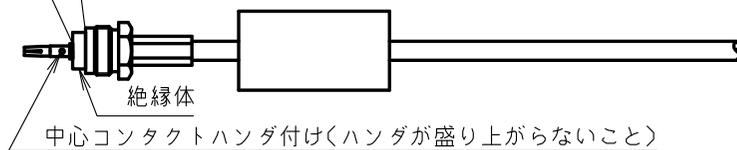
④ 絶縁体、中心コンタクトの順で芯線に装着してハンダ付けをする。
