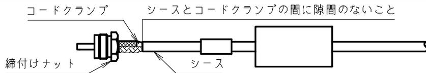
② コードクランプと締付ナットを合わせたものを同軸ケーブルの絶縁体と外部導体の間に挿入する。このとき、シースとコードクランプの間に隙間のないこと。
