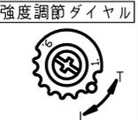
図中の位置で寸法を測定し、クリンプ高さにより工具の強度調整用ダイヤルを設定して下さい。測定位置でのクリンプ高さ3.4mm以下
