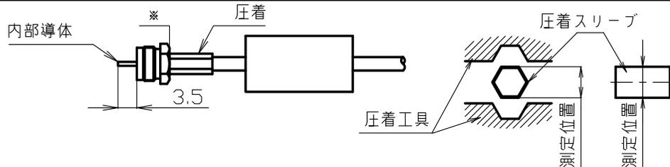
③ 圧着スリーブを図の位置まで上げて圧着工具のA部で圧着する。圧着は工具を出来るだけ締付ナットの根元(※)にあわせて行うこと。次に、同軸ケーブルの絶縁体を切り図中の寸法で芯線を出す。
