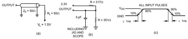
2.5V I/O Test Load
