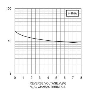
CAPACITANCE BETWEEN TERMINALS:C<sub>t</sub>(pF)
