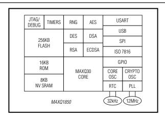
NOTE: THE BLOCK DIAGRAM SHOWS A TYPICAL SYSTEM CLOCK USED TO SUPPORT USB OPERATION AT 12MHz. MULTIPLE EXTERNAL CRYSTAL/CLOCK OPTIONS ARE AVAILABLE.
