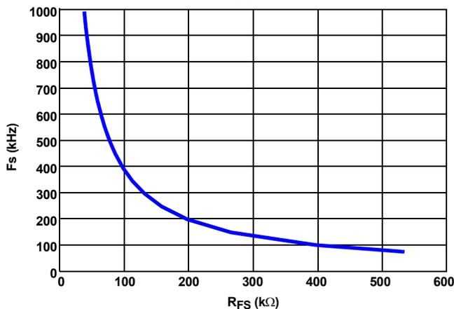
FIGURE 19. R<sub>FS</sub> vs SWITCHING FREQUENCY
