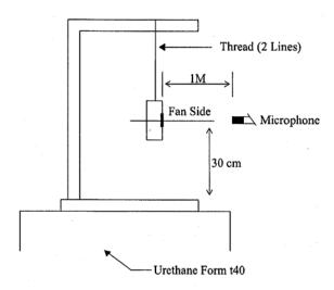
1 METER FROM MICROPHONE TO FAN INTAKE
