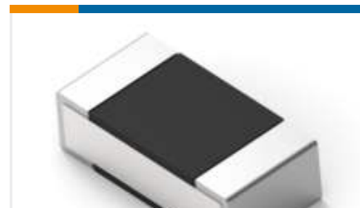
TE Part #6-2176307-3 RP 1E 0.1W 54K9 0.1% 25PPM 5K RL
