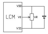
$V_{\mathrm{DD}\sim}V_0$ : LCD Driving voltage
