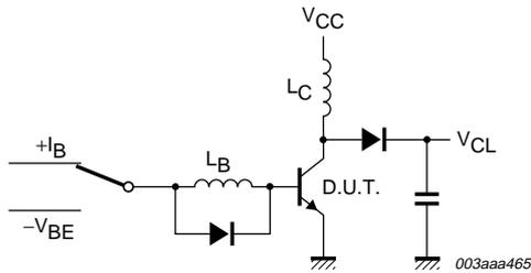
$V_{CL} \leq 1000 \text{ V}$ ;  $V_{CC} = 30 \text{ V}$ ;  $V_{BE} = -1 \text{ V to } -5 \text{ V}$ ;
