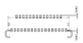
CONNECTOR ON RECOMMENDED PCB LAYOUT
