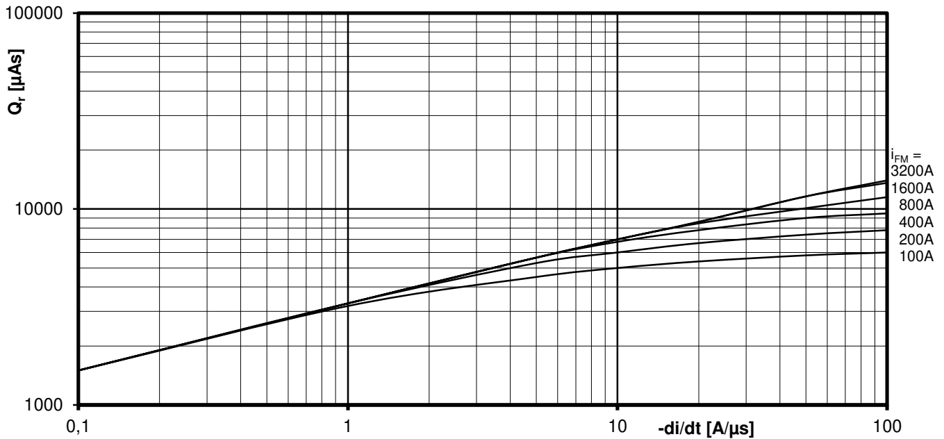
Sperrverzögerungsladung / Recovered charge Q_r = f(-di/dt)
