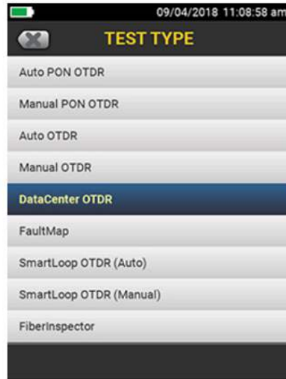
DataCenter OTDR Mode
