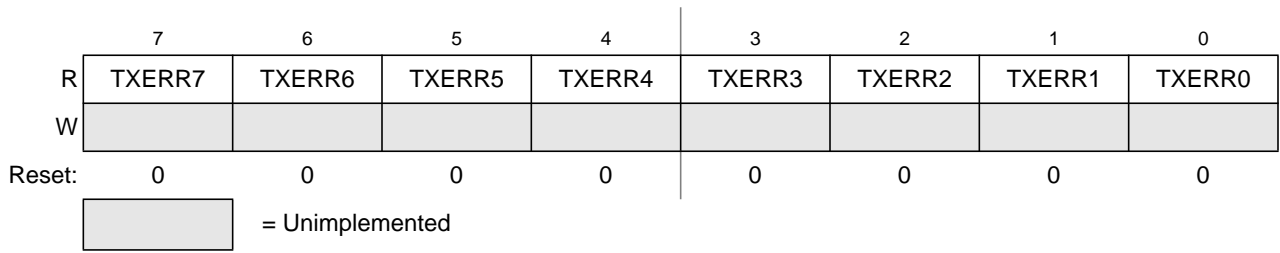
Figure 12-16. MSCAN Transmit Error Counter (CANTXERR)
