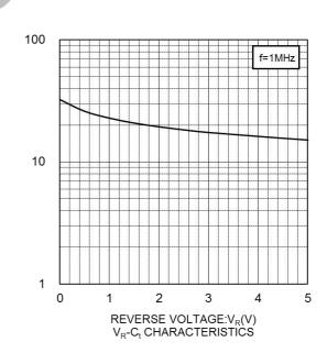
CAPACITANCE BETWEEN TERMINALS:C<sub>(</sub>(pF)
