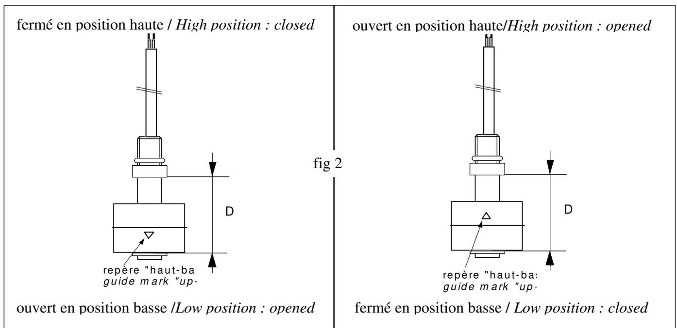
**DETECTION & FONCTION DU CONTACT / DETECTION & OPERATING CONTACT****inversion de la fonctionnalité par inversion du flotteur / Inversion of the function by reversing the float**
